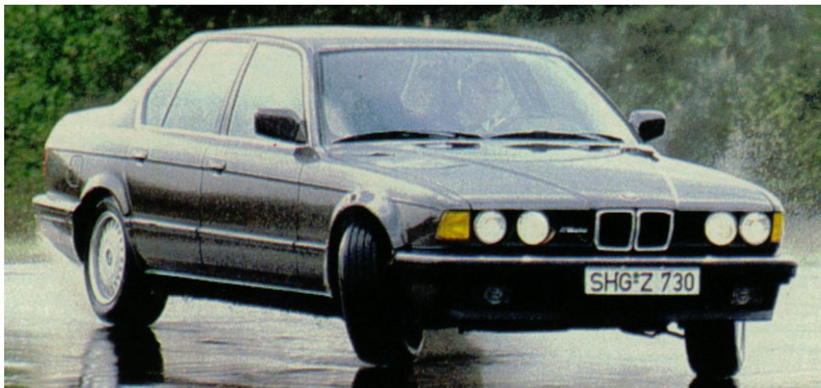
**BMW 730i (1987)** – Motore di 2986 cc con 6 cilindri in linea – 197 HP a 5600 giri – alimentazione ad iniezione (benzina) “Metronic” – cambio a 5 marce più RM – 4 freni a disco con ABS (una delle prime con questo equipaggiamento) – Lunghezza 4.91 m – peso a vuoto 1570 Kg – velocità max. 225.8 Km/h – Consumo 10.5 Km/l
