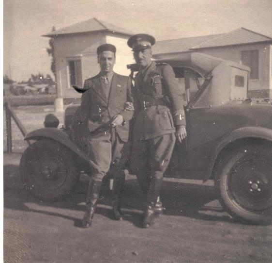
**Fiat 508 Balilla mod. Spider** 3 posti: Motore 4 cilindri 995 cc, 20 CV – cambio a 3 marce non sincronizzate, 4 marce nella versione lusso - lunghezza 3,14 m velocità 85 Km/h- consumo 8,5 litri/100 Km
