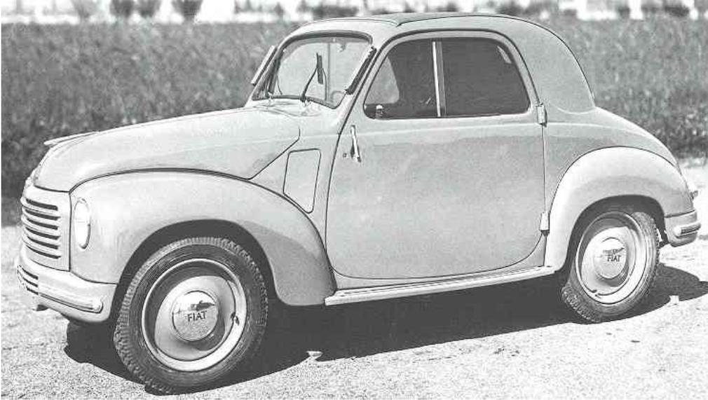
**Fiat 500 C** (1949-55) – Berlina con tetto chiuso o apribile, 2 posti - Motore 4 cilindri in linea di 569 cc con valvole in testa – Potenza 16,5 CV a 4.400 giri con valvole in testa - 4 marce di cui 3a e 4a sincronizzate + retromarcia – Sistema frenante idraulico sulle 4 ruote – Lunghezza 3,21 m – Larghezza 1,27 m – Prestazioni: velocità massima 95 Km/ora; consumo 5 litri per 100 Km.
