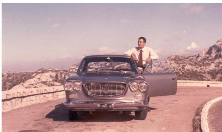
**Lancia Flavia Convertibile – Anno 1962** - Motore 4 cilindri boxer 1500 CC con 2 carburatori doppio corpo – potenza massima 90 CV a 5800 giri – Carrozzeria convertibile Vignale con possibilità Hard-Top – Lunghezza 4,48 m – peso 1160 Kg – Velocità massima 170 Km/h – Consumo 10,1 Km/l
