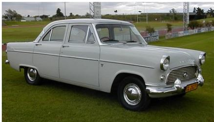
**Ford Consul Mk2** – 1956- 62 – Motore 1703 cc di 4 cilindri in linea con valvole in testa – 59 CV a 4400 giri
