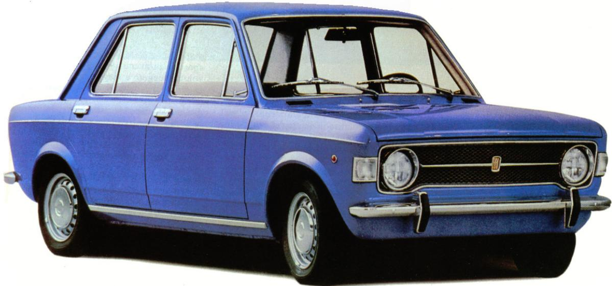
**Fiat 128 – Anno 1969** - motore 4 cilindri in linea 1116 cc 55 Cv a 6000 giri – Velocità massima 135 Km/h – Carrozzeria berlina 3 volumi 4 porte 5 posti - Lunghezza 3,85 m – Peso 770 Kg – Consumo 12 Km/l
