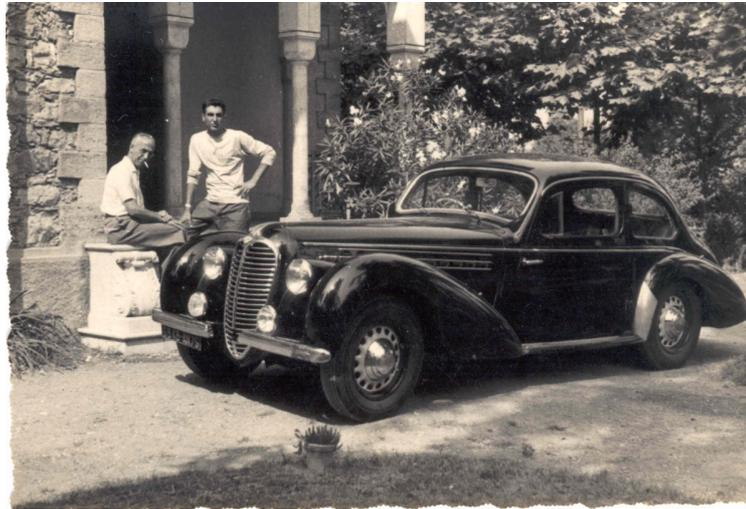
**Delahaye 135 M Coupé** - carrozzeria Dubos – anno 1951- motore 6 cilindri - 3500 cc -120 CV - velocità massima 160 Km/h
