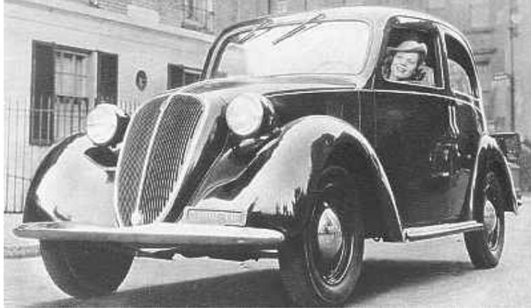
**Fiat 1100 A** – 1937/39 – Motore anteriore 4 cilindri in linea di 1089 cc con valvole in testa – Potenza 32 CV a 4400 giri/m – Lunghezza 4,02 m Larghezza 1,48 m – Peso 890 Kg – Velocità max 110 Km/ora – Consumo medio 9 litri per 100 Km – Carrozzeria 4 porte con apertura al centro vettura.
