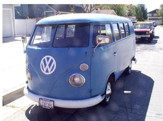
**Volkswagen Kombi 6 volt (1957)** Motore post. 4 cil. boxer 1200 cc; Furgone sfinestrato 3 porte + portellone posteriore; Velocità max 120 Km/h – Lunghezza 4.42 m – Consumo 10,5 Km/l
