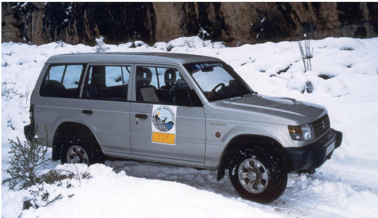
**Mitsubishi Pajero – Anno 1995** – Motore Turbo Diesel 2900 cc – Potenza 125 CV - Carrozzeria passo lungo 5 porte 5 posti – lunghezza 4.75 m., larghezza 1.80 m. – Velocità max. 165 Km/h- consumo 10 litri/100 Km - 4 ruote motrici con blocco differenziali centrale e posteriore – attrezzata per “all terrain”
