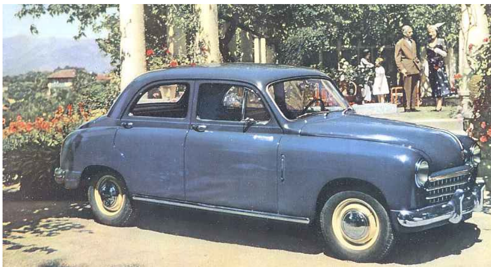
Fiat 1400 anno 1950, motore 4 cilindri 1400 cc., 44 CV a 4400 giri, velocità massima 120 km/h, peso 1120 kg – Cambio al volante come nelle vecchie macchine americane.
