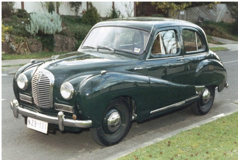
Austin A40 Somerset – (1952-54) – Motore 1200 cc a benzina di quattro cilindri in linea – Potenza 42 CV a 4300 giri – Trazione posteriore – 4 posti, 4 porte – Velocità massima 120 Km/ora
