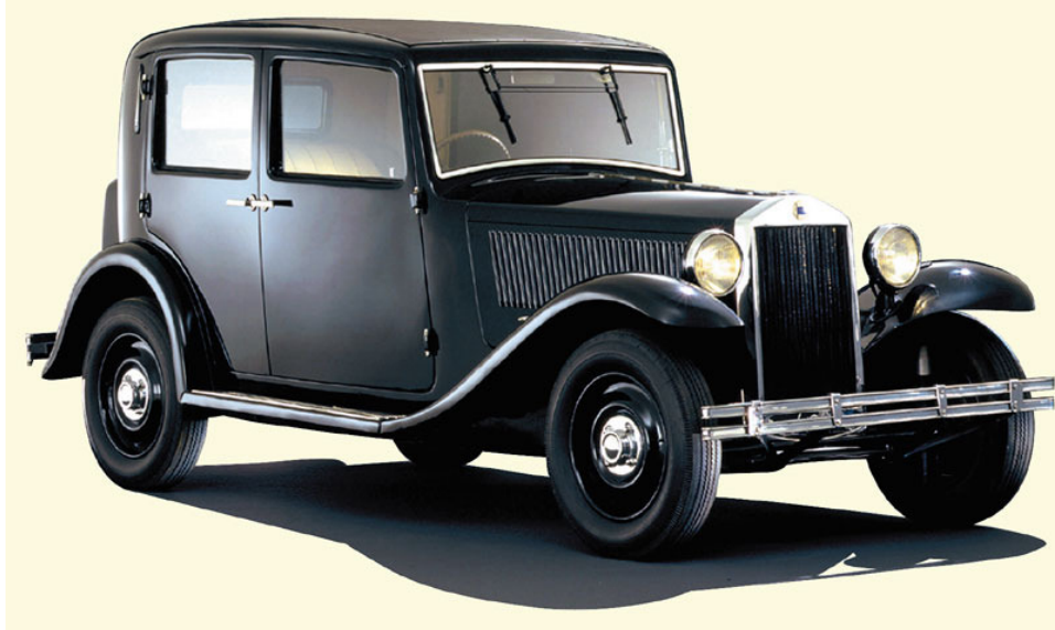
Lancia Augusta (1933) – Motore 4 cilindri a V di 1196 cc – 35 CV a 4000 giri – Lunghezza 3,81 m, larghezza 1,45 m - Peso 840 Kg - Quattro posti, guida a destra , quattro porte con apertura al centro vettura - Velocità massima 102 Km/ora
