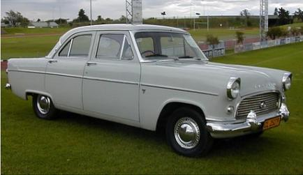
**Ford Consul Mk2 – 1956- 62 – Motore 1703 cc di 4 cilindri in linea con valvole in testa – 59 CV a 4400 giri lunghezza 4,37 m - velocità max. 125 Km/h – consumo 8,5/100 Km (12.5Km/litro)**
