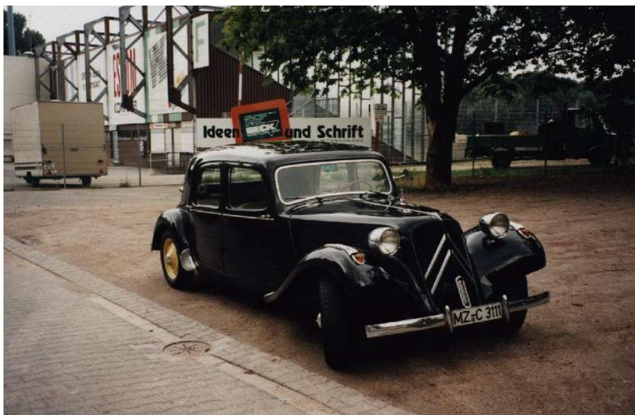
**Citroën Traction Avant 11 BL – Anno 1937** – motore 4 cilindri in linea 1911 CC – potenza 46 CV – Cambio a tre rapporti con leva sul cruscotto + RM – Velocità massima 120 Km/h – Consumo 8-10 Km/l – Carrozzeria berlina 4 porte 4 posti - Lunghezza 4,38 m - peso 1050 Kg
